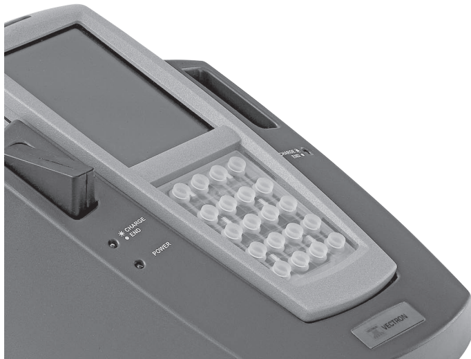
Abb. 36: Tastenkappen von der Tastaturmatte entfernt
