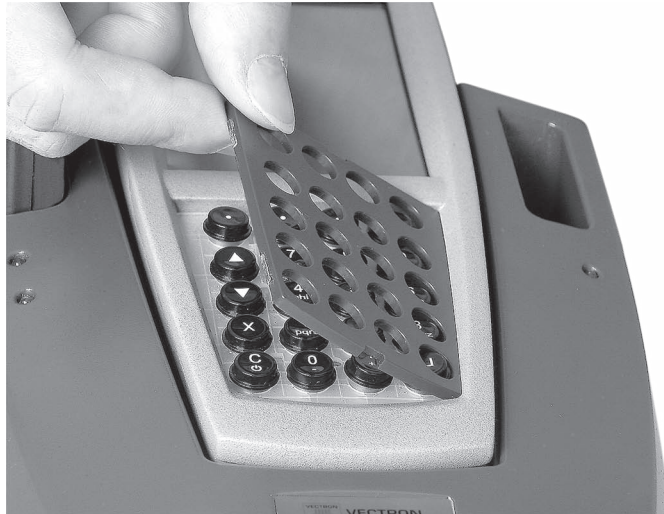
Abb. 38: Tastenführungsgitter seitlich einsetzen
