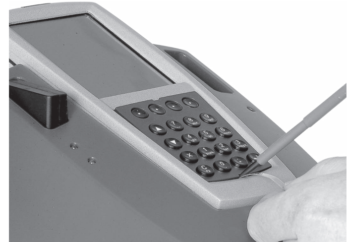
Abb. 34: Tastenführungsgitter unten hochdrücken
