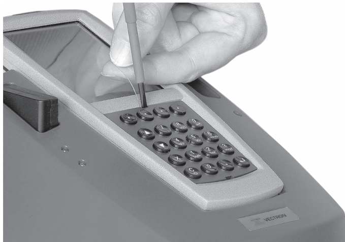
Abb. 33: Tastenführungsgitter oben hochdrücken
