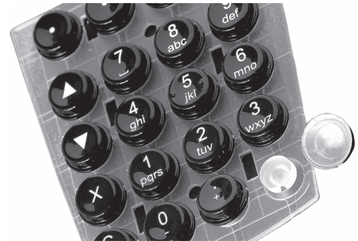
Abb. 37: Tastaturkappen auf die Tastaturmatte setzen
